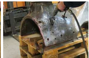
boren 5 mm met mal boren 8 mm met mal
