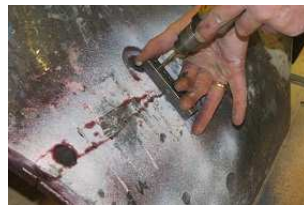
boren 5 mm met mal boren 8 mm met mal
