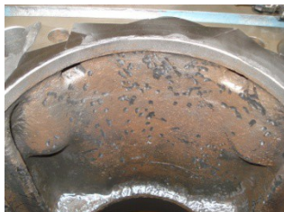
Cavitatie uitgefreesd in motorblok naar originele maatvoering
